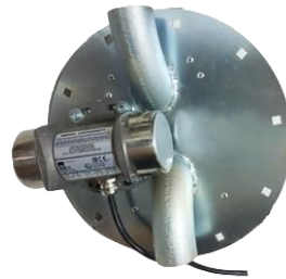
Ensemble du vibreur dans la bouche du silo.
